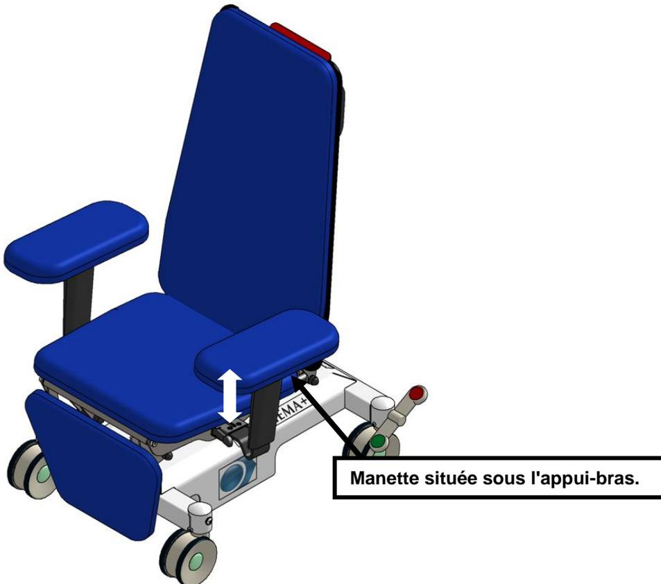
Pour enlever l'appui-bras, faire pivoter le levier situé à la base de l'appui-bras pour déverrouiller ce dernier. Retirez l'appui-bras au complet.
